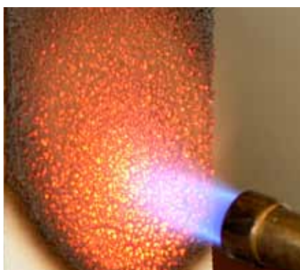
Brandwerende coating schuimt op door verhitting
