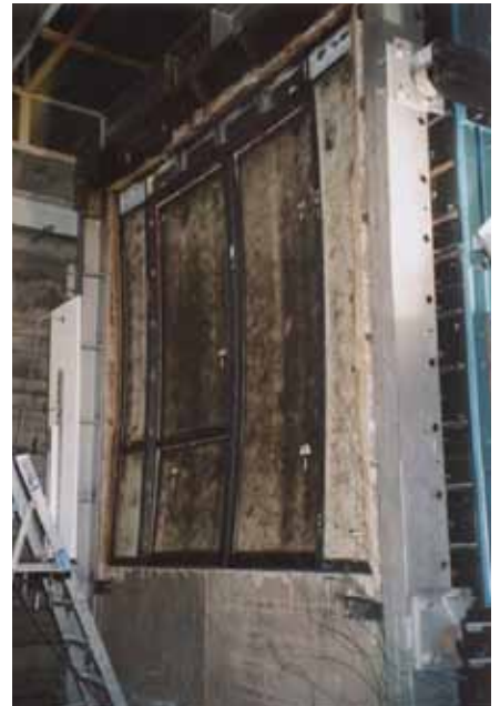
Brandproef van een schuifpui 3,2 m l hoogte met brandwerend glas (het brandwerende glas is reeds opgeschuimd).
